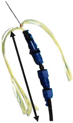
1 Kevlar length preparation => 90 mm. Longueur de préparation du Kevlar
